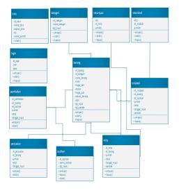
Class diagram digunakan untuk melakukan visualisasi struktur kelas-kelas dari suatu sistem. Class diagram juga dapat memperlihatkan hubungan antar kelas dan penjelasan detail tiap-tiap kelas di dalam model desain (logical view) dari suatu sistem. proses desain, class diagram berperan dalam menangkap struktur dari semua kelas yang membentuk arsitektur sistem yang dibuat
