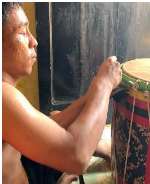
Gambar 4. Pemasangan Membran (sumber : Michael Mangaranap Siregar)
